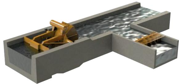
Si hay que alimentar otras derivaciones aguas abajo donde la lámina de agua fluctúa más que la carrera permitida por los Módulos, se puede intercalar entre el canal principal y la toma de la derivación, una compuerta AB1 (ver Figura N°5).
